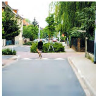
**Bild 18: Linksversatz in Kombination mit Aufpflasterung am Knotenpunkt**
