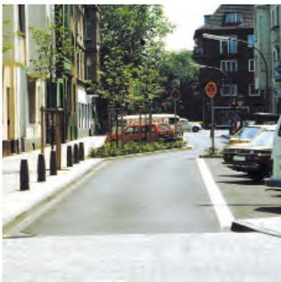
**Bild 17: Rechtsversatz auf der Strecke ermöglicht den Linksversatz am Knotenpunkt**
